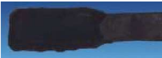
Grundmaß 18 x 24 mm – nach 2 Stunden ist das Grundmaß auf 28 x 36 mm angewachsen
