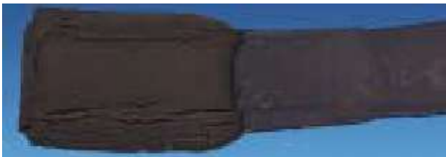
Versuchsprofil 12 x 25 mm – nach 2 Stunden ist das Versuchsprofil auf 24 x 48 mm angewachsen
