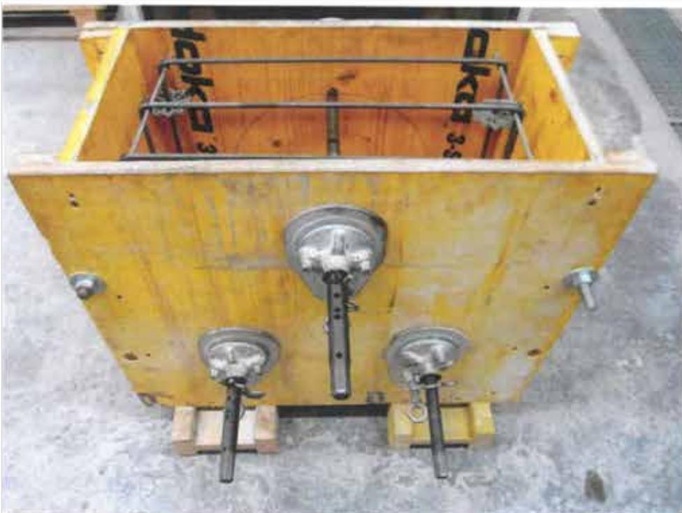
Bild 2: Prüfkörperschalung mit 3 Spannstellen des Ankersystems
