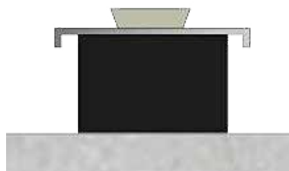
B) Befestigung von CEMswell® mit Montageschiene
