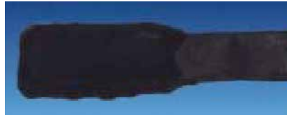
Grundmaß 18 x 24 mm – nach zwei Stunden ist das Grundmaß auf 28 x 36 mm angewachsen
