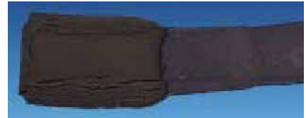
Versuchsprofil 12 x 25 mm – nach zwei Stunden ist das Versuchs- profil auf 24 x 48 mm angewachsen
