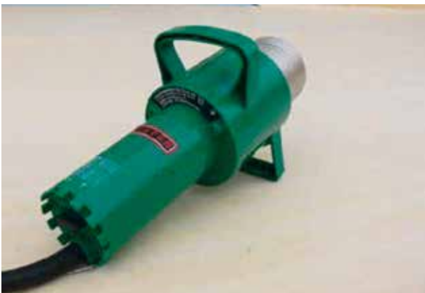
Beispiel für ein Heißluftgerät zum Vorwärmen der Stöße und Tapes
