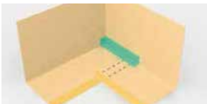
5. Freien Rand zurückschneiden, zur Vermeidung einer Kapillare
