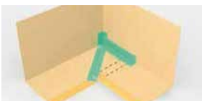
6. Überlappungsstoß ausbilden und Innentape Sika® Proof Tape-150 anbringen
