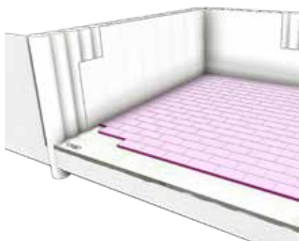
Wand gegen Verbau mit Ausgleichsschicht
