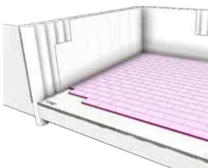
Wand gegen Verbau mit Ausgleichsschicht
