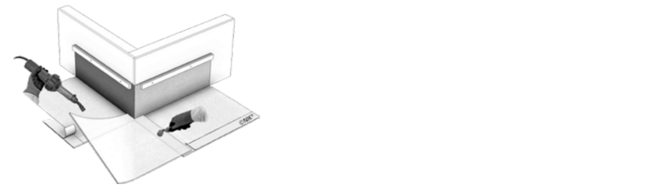
Ausführung thermische Fügung, Vlies im Fügebereich entfernen
