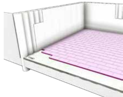
Wand gegen Verbau mit Ausgleichsschicht
