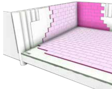
Wand mit Perimeterdämmung
