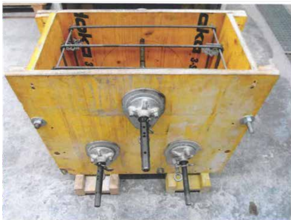
Bild 2: Prüfkörperschalung mit 3 Spannstellen des Ankersystems
