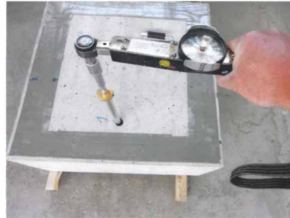
Bild 3: Einsetzen eines NIK-Dichtungseinsatzes 19x70 mm
