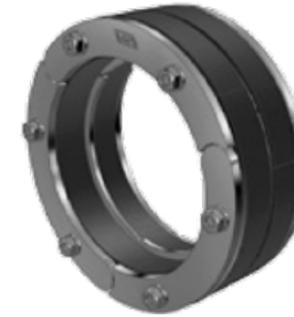
Ringraumdichtung RRD-WR1 aus EPDM-Gummi, 1-lagig gegen nicht drückendes Wasser, in geteilter Ausführung und integriertem Stützring, Metallteile aus A2 Edelstahl.
