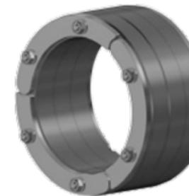
Ringraumdichtung RRD3 aus EPDM-Gummi, 3-lagig gegen drückendes Wasser, Metallteile aus A2 Edelstahl.
