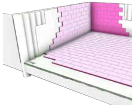
Wand mit Perimeterdämmung
