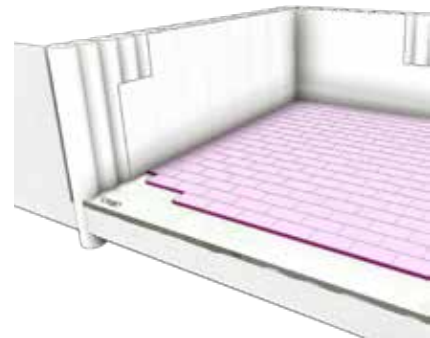
Wand gegen Verbau mit Ausgleichsschicht
