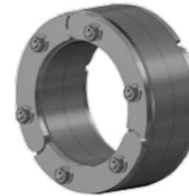
Ring-Raum-Dichtung RRD2 aus EPDM-Gummi, 2-lagig gegen drückendes Wasser, Metallteile aus A2 Edelstahl.
