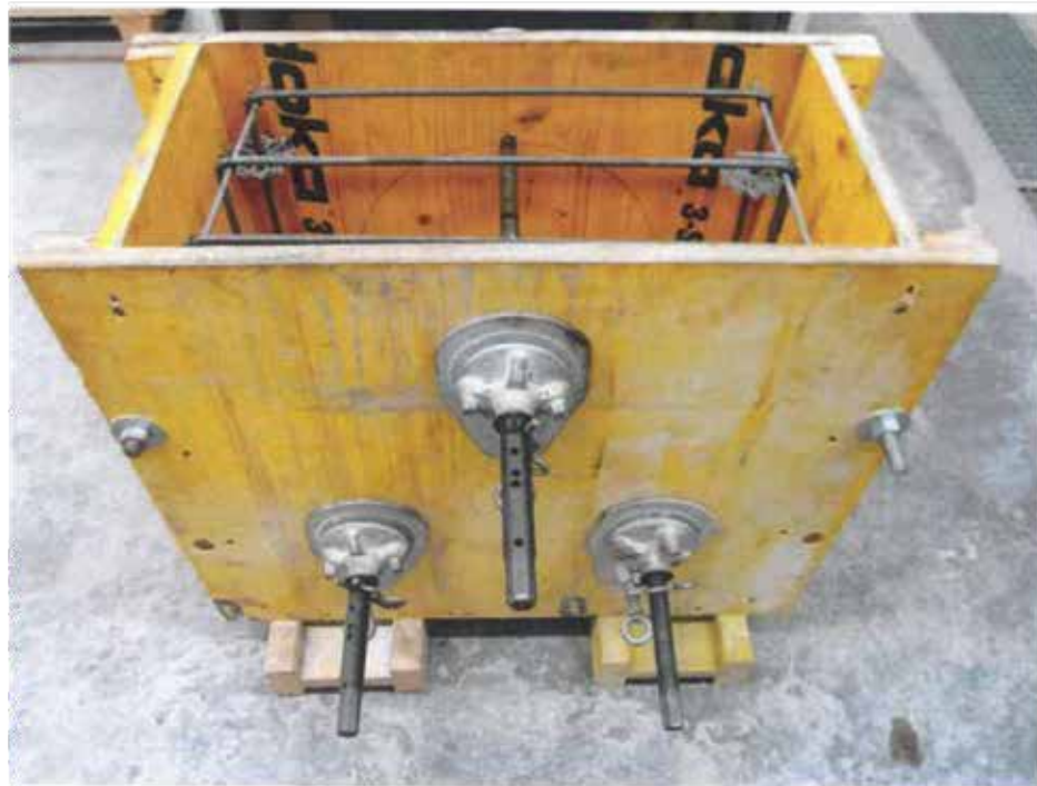
Bild 2: Prüfkörperschalung mit 3 Spannstellen des Ankersystems
