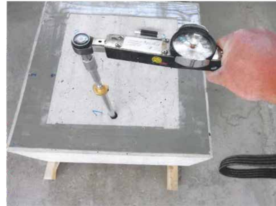
Bild 3: Einsetzen eines NIK-Dichtungseinsatzes 19x70 mm
