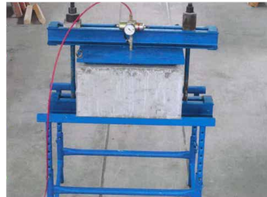
Bild 4: Prüfkörper mit eingebauten NIK-Dichtungseinsätzen vor dem Beginn der Prüfung
