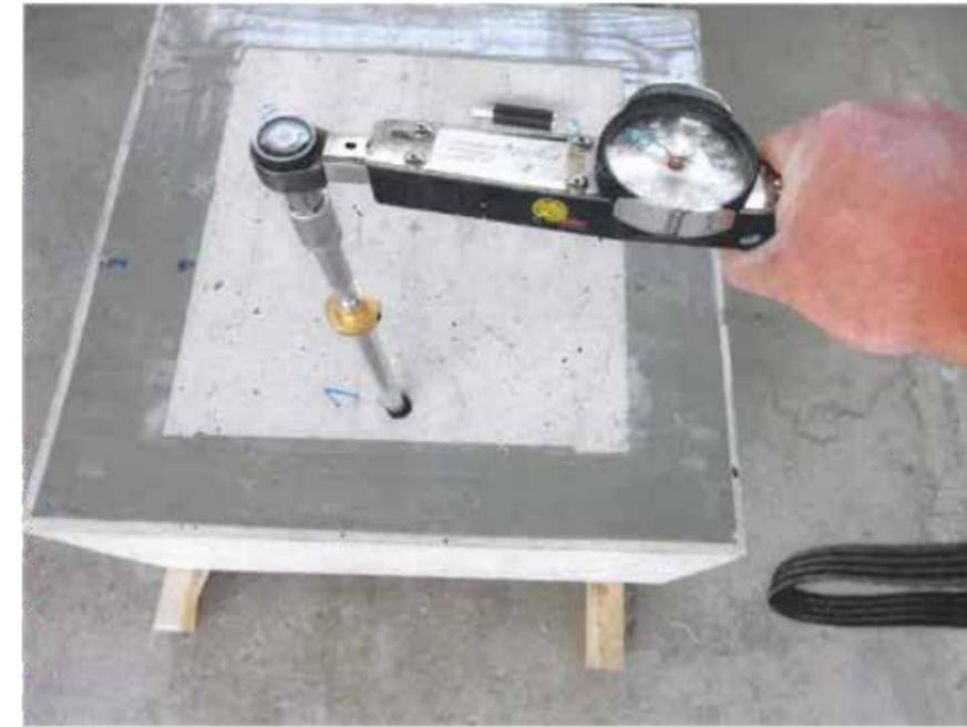
Bild 3: Einsetzen eines NIK-Dichtungseinsatzes 19x70 mm
