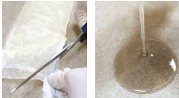
3. Streichen Sie das Material nach unten ab und schneiden Sie den Beutel an einer Ecke vorsichtig auf
