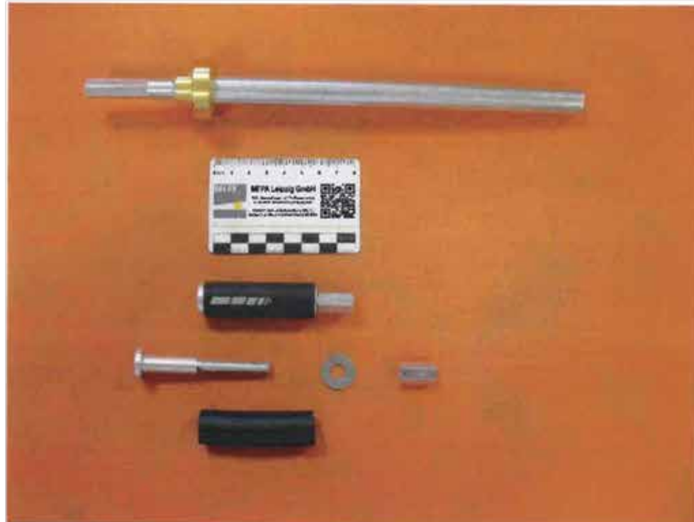
Bild 1: NIK-Dichtungseinsatz 19x70 mm, montiert und demontiert sowie zugehöriger Montageschlüssel (oben)
