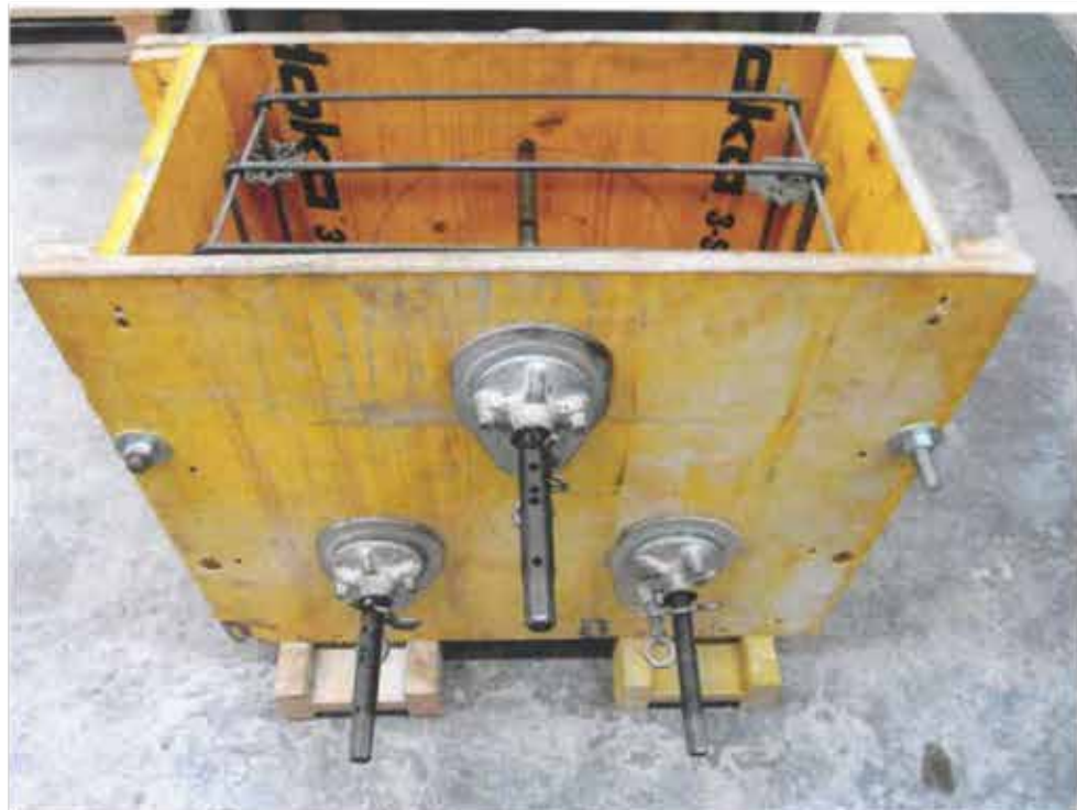
Bild 2: Prüfkörperschalung mit 3 Spannstellen des Ankersystems
