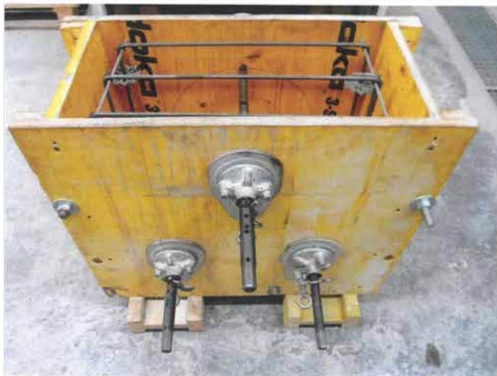
Bild 2: Prüfkörperschalung mit 3 Spannstellen des Ankersystems
