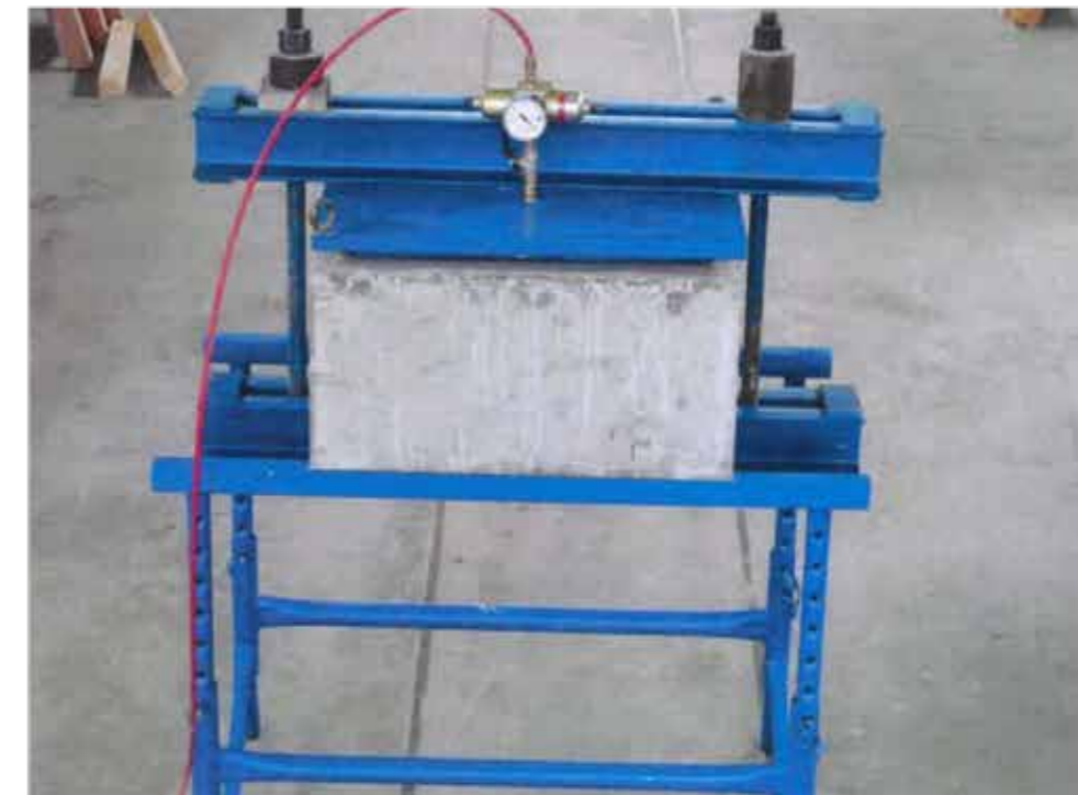
Bild 4: Prüfkörper mit eingebauten NIK-Dichtungseinsätze vor dem Beginn der Prüfung
