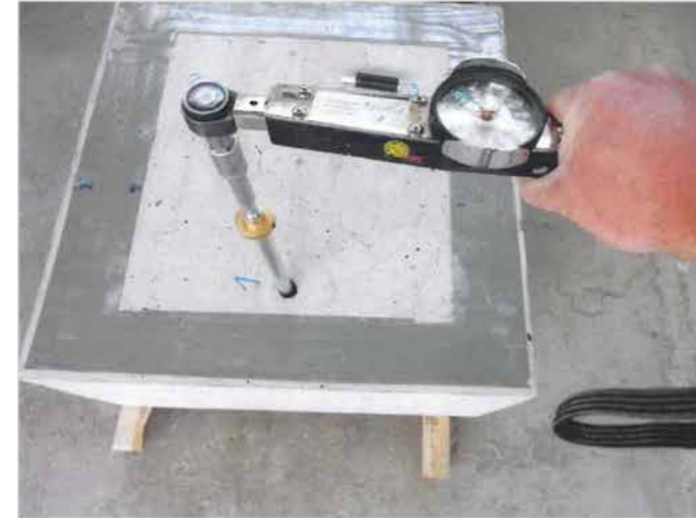
Bild 3: Einsetzen eines NIK-Dichtungseinsatzes 19x70 mm
