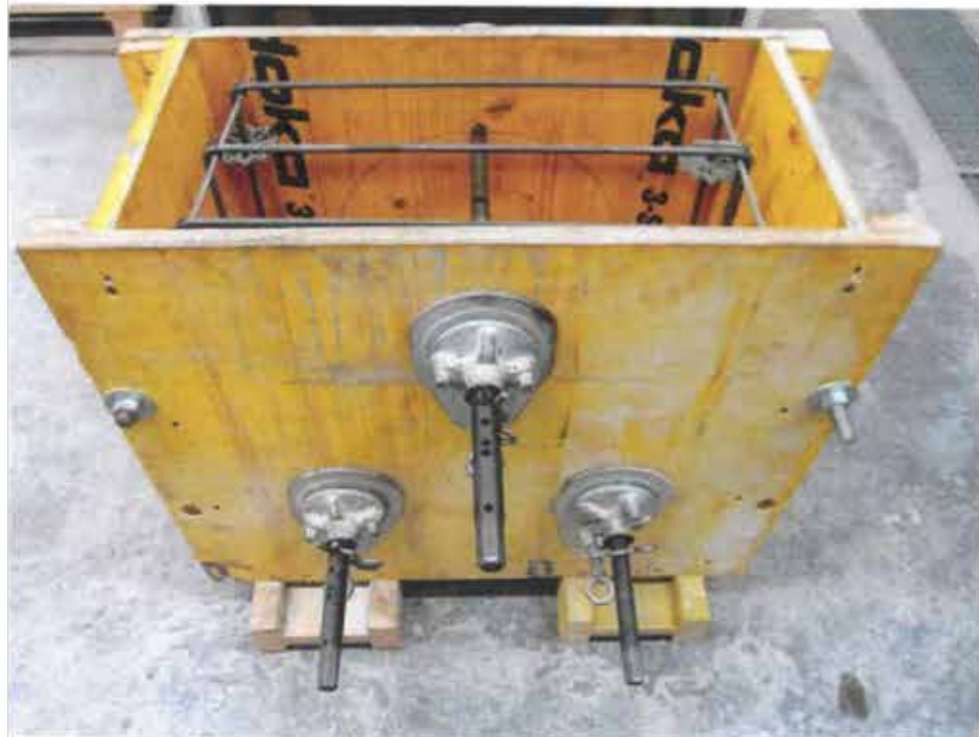
Bild 2: Prüfkörperschalung mit 3 Spannstellen des Ankersystems
