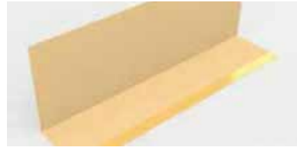
1 geformte Bahn einlegen
