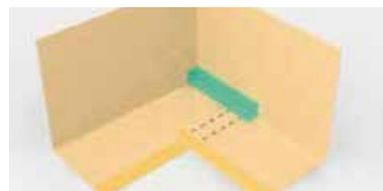
5 Freien Rand zurückschneiden, zur Vermeidung einer Kapillare
