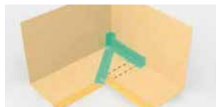
6 Überlappungsstoß ausbilden und Innentape SIKA®Proof Tape-150 anbringen
